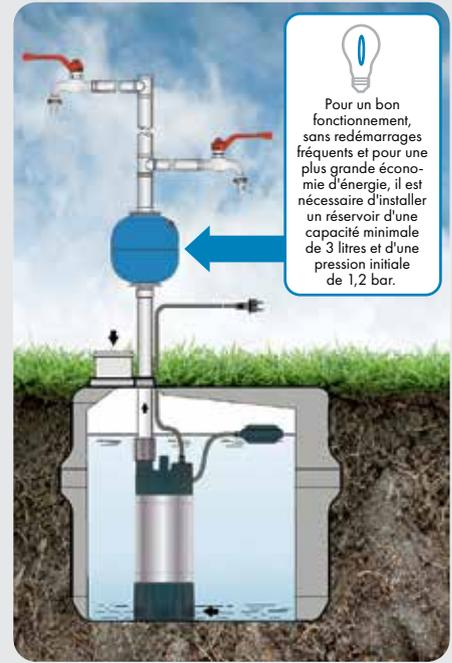
Pour un bon fonctionnement, sans redémarrages fréquents et pour une plus grande économie d'énergie, il est nécessaire d'installer un réservoir d'une capacité minimale de 3 litres et d'une pression initiale de 1,2 bar.
