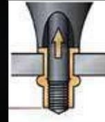
2. Prenez les pinces et mettez l'écrou du rivet aveugle par-dessus et tapez l'arrière de l'écrou dans le trou. La pince tire alors l'arrière de l'écrou du rivet vers l'arrière, ce qui le déforme à l'extérieur et le verrouille en place.
