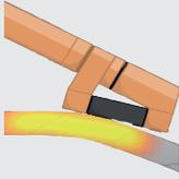
Consiste à remettre en forme une pièce qui a été déformée, tordue ou pliée. Ce processus vise à restaurer l'état original de la pièce. L'objectif est d'éliminer les déformations sans compromettre les propriétés mécaniques de la pièce, afin de la rendre utilisable et fonctionnelle.
