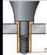
1. Percez un trou dans la construction de la taille de l'écrou de rivet que vous choisissez.
