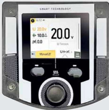
La série GALAXY sont des postes à souder inverter. Son mode MIG/MAG pulsé offre un contrôle très précis de l'énergie de soudage réduisant ainsi les déformations des pièces à souder. Les synergies pulsées augmentent les vitesses de soudage et diminuent les projections tout en améliorant l'esthétique du cordon
